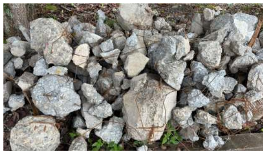
Gambar 1. 1 Limbah Beton Mini Pile (Sumber : Dokumentasi Pribadi, 2026)
